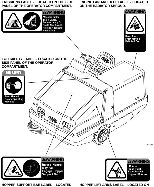
HOPPER LIFT ARMS LABEL - LOCATED ON BOTH HOPPER LIFT ARMS.
