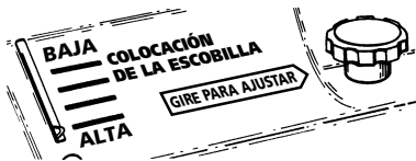
Figura 5 - Ajuste de la Escobilla Principal
