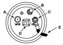
TYPICAL LPG LIQUID WITHDRAWAL FUEL TANK
