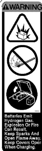
**BATTERY CHARGING LABEL - LOCATED ON THE UNDERSIDE OF THE SOLUTION TANK.**
