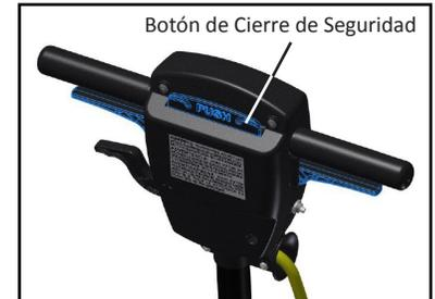
Una vez que haya establecido la altura del mango y usted esté en la posición del operador, presione el botón de Cierre de Seguridad (Safety Lock) con sus pulgares y encienda la unidad presionando el estribo izquierdo, el derecho, o, de ser posible, en ambos estribos de conmutación. Comience a moverse hacia adelante en líneas rectas. Controle la almohadilla cada 15 o 30 minutos (según la almohadilla que se esté utilizando) para mantener un desempeño óptimo.
