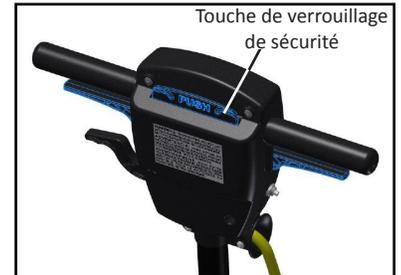
Une fois que vous avez ajusté la hauteur de la poignée selon vos préférences et que vous voulez l'utiliser, appuyez sur la touche de verrouillage de sécurité avec les pouces et allumez l'appareil en appuyant soit sur le levier de la droite ou de la gauche ou sur les deux leviers de commutation. Commencez à avancer en lignes droites. Vérifiez votre patin toutes les 15 à 30 minutes (selon le type de patin utilisé) afin de maintenir la meilleure performance.
