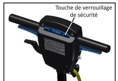
Lorsque la hauteur de la poignée est réglée selon vos préférences et vous êtes dans la position de l'opérateur, appuyez sur la touche de verrouillage de sécurité avec les pouces et démarrez l'appareil en appuyant soit à gauche, soit à droite, ou de préférence sur les deux leviers. Commencez à avancer en ligne droite. Vérifiez votre patin toutes les 15 à 30 minutes (selon le patin en cours d'utilisation) pour maintenir les meilleures performances.
