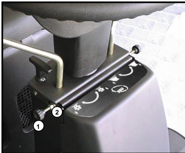
FIG. 8 - REGULACIÓN DEL CEPILLO CENTRAL
