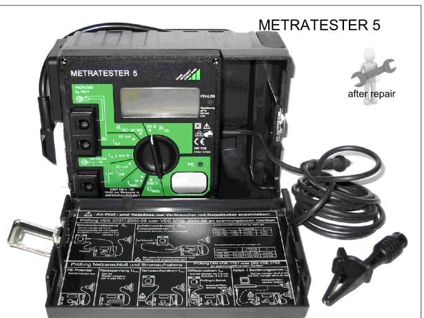
Das Prüfgerät ist zum Prüfen und Messen an instandgesetzten oder geänderten elektrischen Geräten nach DIN VDE 0701 oder DIN VDE 0702 bestimmt. Gemäß diesen Vorschriften müssen nach einer Instandsetzung oder Änderung elektrischer Geräte der Schutzleiterwiderstand, der Isolationswiderstand, der Ersatz-Ableitstrom und bei Datenverarbeitungs-Einrichtungen und Büromaschinen die Spannungsfreiheit berührbarer leitfähiger Teile gemessen werden.
